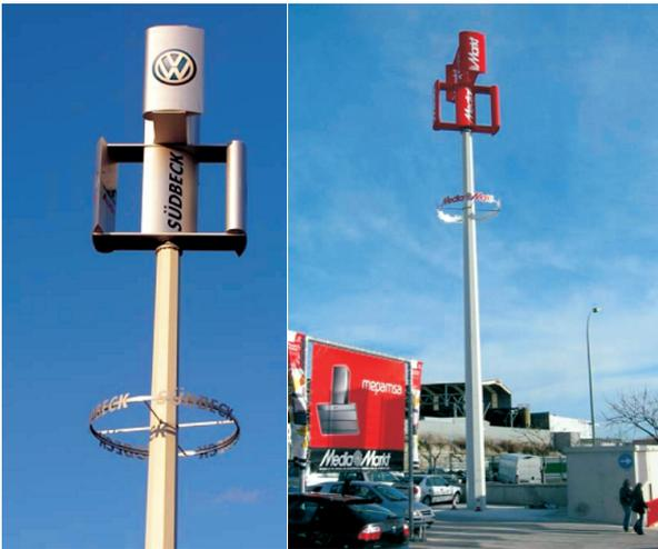
Hoje em dia, poucas empresas fabricam turbinas eólicas de eixo vertical. A grande vantagem deste tipo de turbina eólica é o facto de o gerador se encontrar na base e de poder captar os ventos sem necessidade de um mecanismo de orientação.<sup>8</sup>
